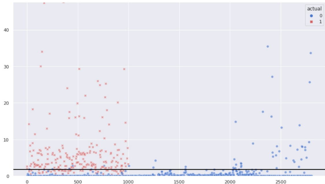
Рисунок 30 — Распознанные аномалии и пороговые значения на последовательностях < 1000 символов
